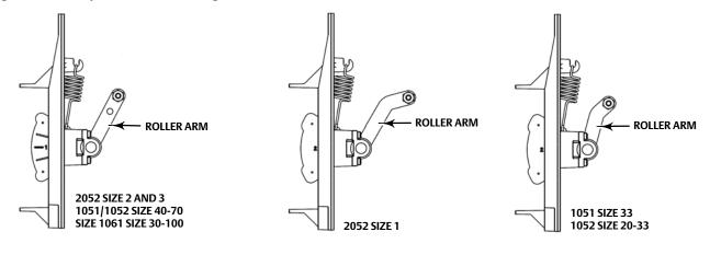
NOTE THE DIFFERENCE IN THE SHAPE AND LENGTH OF THE ROLLER ARM
